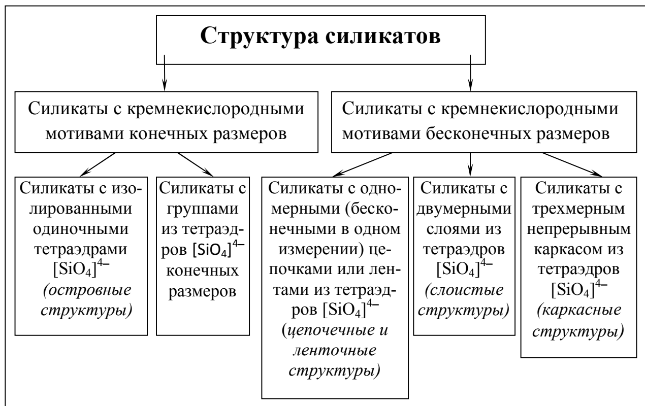
Рис. 18. Структурная классификация силикатов
